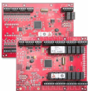
コントローラーとサブパネル
